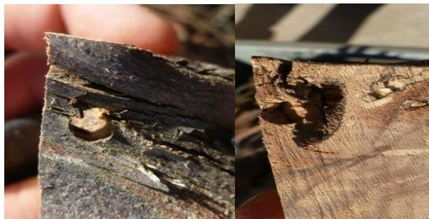
Figura 3: Detalle de cámara ninfal (Dcha.) con orificio de salida hacia el exterior. (Izq.)
